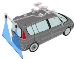
Dal video rilievo, in post processing vengono creati grani di rete quanti sono i temi da analizzare (*shapefile*), ogni shapefile rappresenta lo stato di manutenzione del tema prescelto in una scala di qualità (*da 1 a 5*) rappresentata graficamente da diversi colori.
